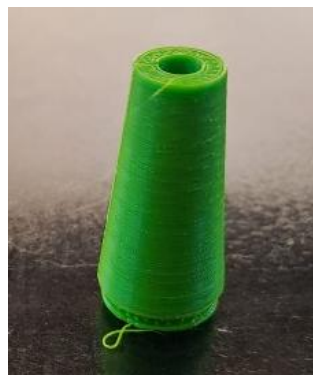
Fig. 27. Reperul mâner la sfârșitul operației de printare
